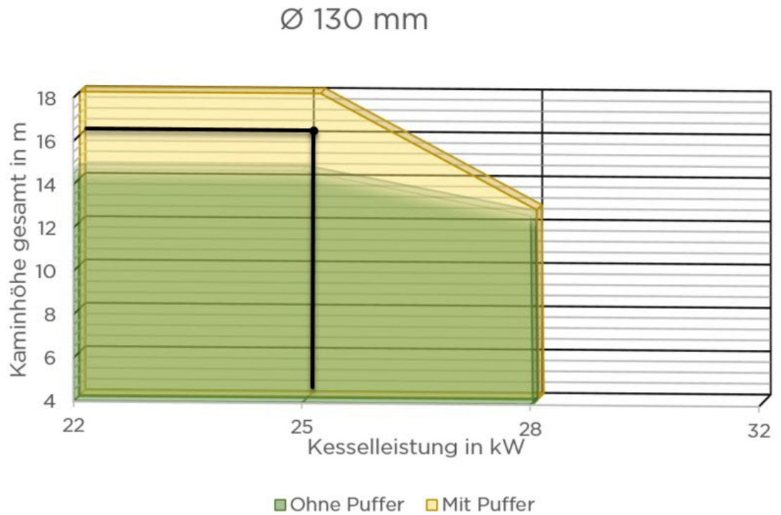
Abb. 3: Maximal zulässige Kaminhöhe bei gegebener Kesselleistung
