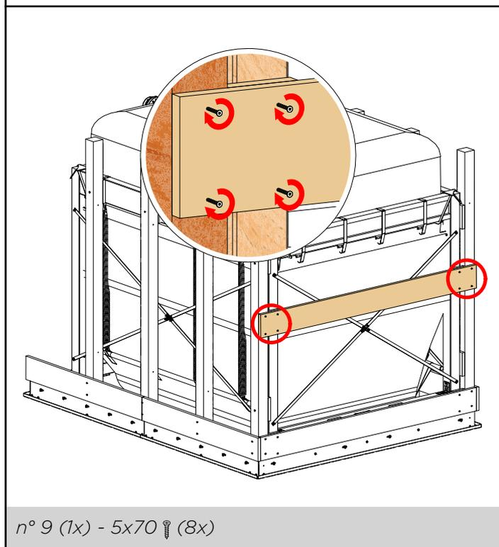
2. Placez et vissez les deux planches latérales dans la partie intermédiaire du silo (10 vis par côté).
